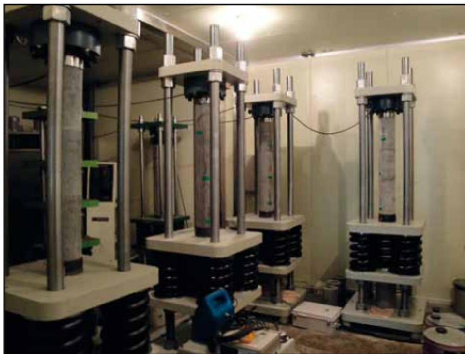
Hình 11.4 - Đo biến dạng từ biến từ các mẫu bê tông trong buồng khí hậu.
