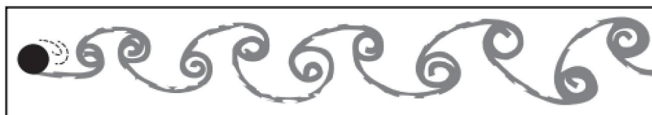
Hình 9.1 - Biểu diễn giản đồ 2D của các xoáy được tạo ra khi gió tác động vào vật hình trụ
