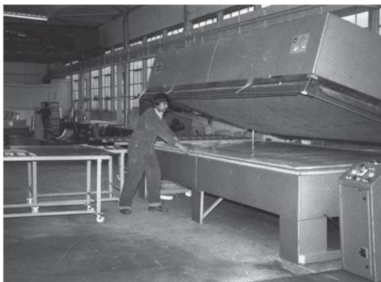
Hình 1.10 – Sản xuất panen nhiều lớp sử dụng máy ép chân không [9]
