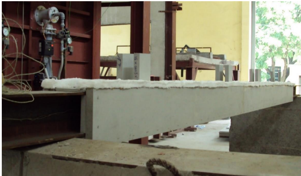
Hình 36 – Bọc bảo vệ chịu lửa cho mẫu đầm thép tiết diện I bằng tấm Silicate (trước khi TN)
