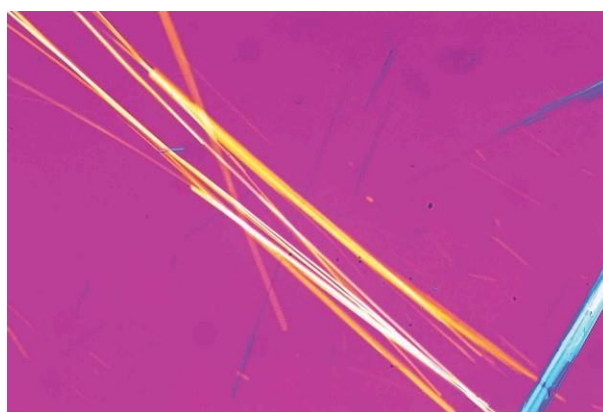
Hình D.24 - Ảnh hiển vi PLM của SRM 1866 tremolite trong chất lỏng 1.625 RI - Các cực chéo với tấm làm chậm 530 nm
