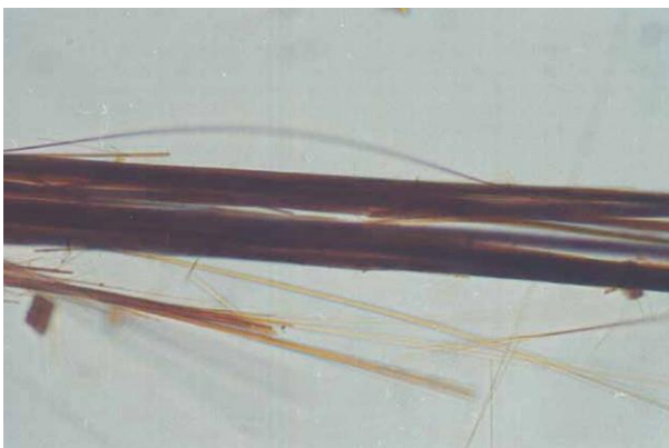
Hình D.9 - Amosite đã nung đặt trong chất lỏng 1.680 RI, được quan sát qua bản mặt phân cực ánh sáng - Chiều dài sợi song song với hướng rung của bản phân cực
