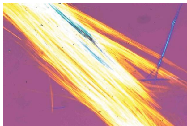
Hình D.50 - Ảnh hiển vi PLM của amiăng richterite/winchite trong chất lỏng 1.630 RI - Các cực chéo với tấm làm chậm 530
