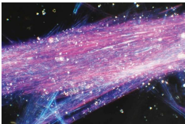
Hình D.51 - richterite/winchite trong chất lỏng 1.630 RI, quan sát được nhuộm phân tán – vị trí sợi tắt sáng
