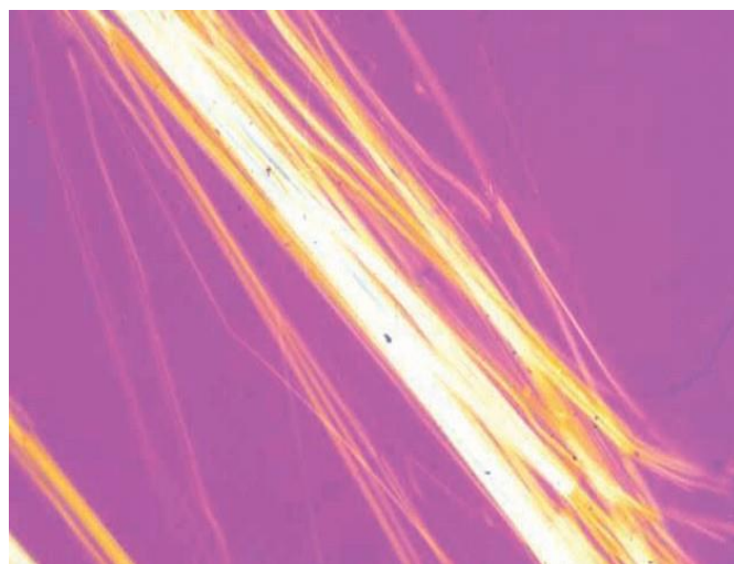
Hình D.2 – Ảnh hiển vi PLM của chrysotile SRM 1866 trong chất lỏng 1,550 RI Các cực chéo với tấm làm chậm 530 nm
