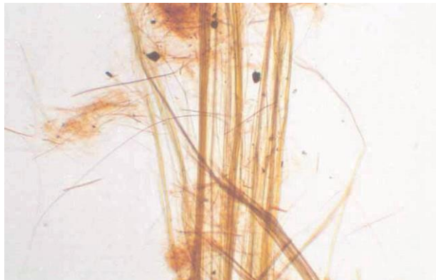
Hình D.18 – crocidolite nung, được quan sát dưới ánh sáng phân cực - Chiều dài sợi vuông góc với hướng rung của bản phân cực
