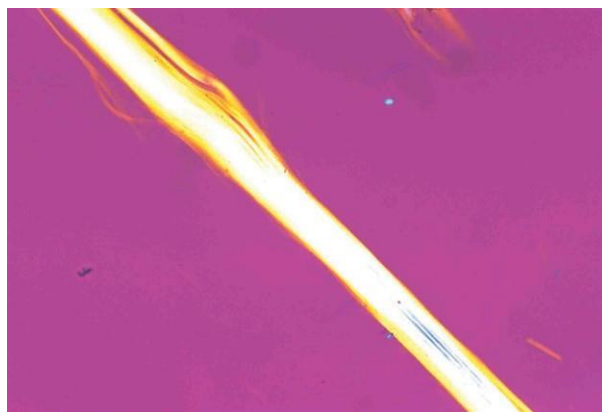
Hình D.36 - Ảnh hiển vi PLM của HSE tremolite trong chất lỏng 1.605 RI - Các cực chéo với tấm làm chậm 530 nm
