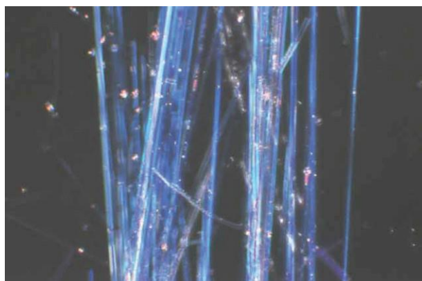
Hình D.34 – SRM 1867 anthophyllite trong chất lỏng 1,630 RI, quan sát được nhuộm phân tán - Chiều dài sợi vuông góc với hướng rung của bản phân cực
