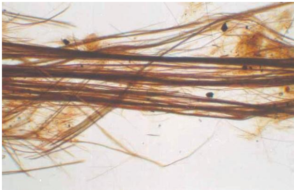
Hình D.17 – crocidolite nung, được quan sát dưới ánh sáng phân cực - Chiều dài sợi song song với hướng rung của bản phân cực
