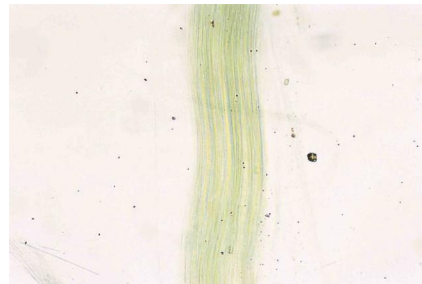
Hình D.44 – HSE actinolite trong chất lỏng 1.640 RI, qua bản mặt phân cực ánh sáng - Chiều dài sợi song song với hướng rung của bản phân cực
