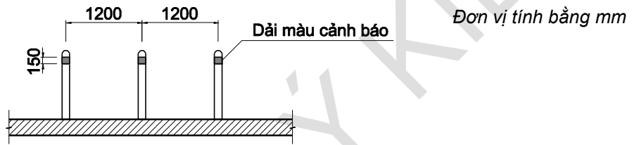
Hình 28 - Khoảng cách an toàn giữa các cọc đứng độc lập
